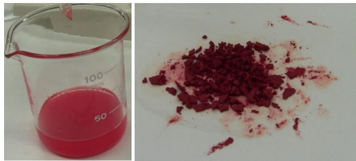
写真5. ベンゼンジアゾニウム塩と2-ナフトールのカップリング 溶液の色: 赤 沈殿の色: 赤
